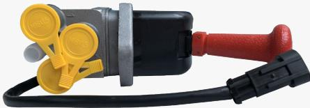
**Válvula de Freno de mano 3 entradas / salidas laterales con switch de luz**
