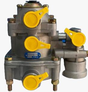
**Válvula de control remolque
