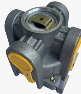
**Válvula Relay RG-2 tipo Haldex**
